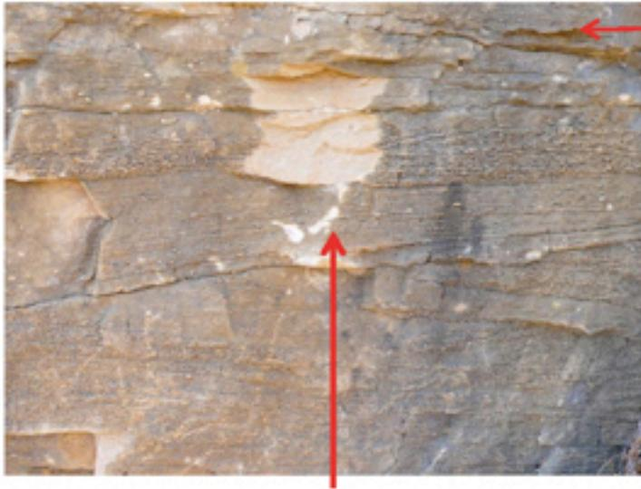
Lauze : 5 cm d'épaisseur, débitée et utilisée pour fabriquer des tuiles : zone de dépôt plus calme
